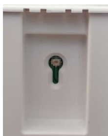
Рисунок 3.1 — U.FL-разъем для подключения GSM-антенны
